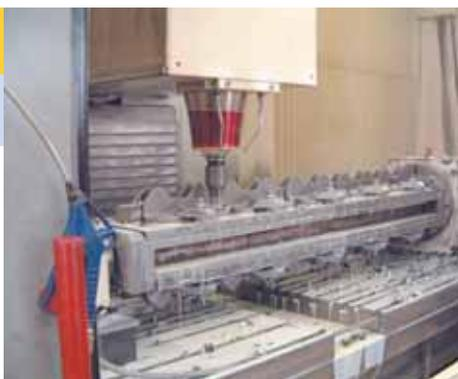
Lavorazione in due fasi di staffe montate su attrezzatura indexabile L2500 mm
