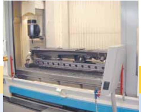
Lavorazione di tre facce di una struttura saldata L3500 mm su attrezzatura indexabile
