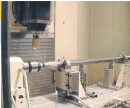
Fresatura, foratura e dentatura di albero L2800 mm in unico piazzamento
