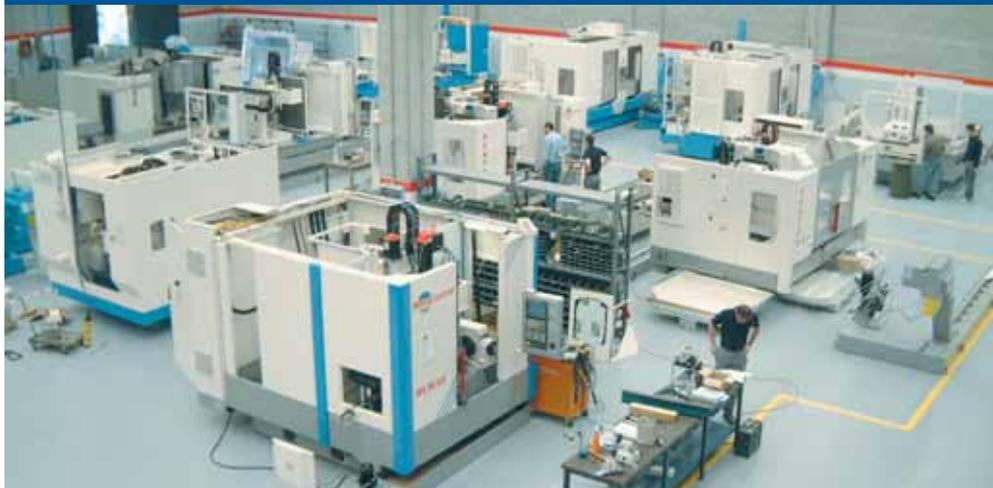
REMACONTROL è dedicata alla produzione di centri di lavoro verticali a montante mobile coprendo campi di lavoro da 1000x500 mm a 12000x1000 mm. Oltre alla grande flessibilità di utilizzo, la configurazione dei propri centri di lavoro permette alla REMACONTROL una facile integrazione (delle macchine) in celle di lavoro a concezione modulare.
