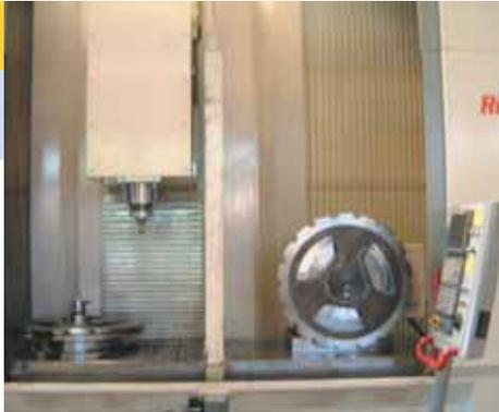
Lavorazione pendolare in due fasi di ruota di trazione: 1a fase piatta, 2a fase su tavola girevole
